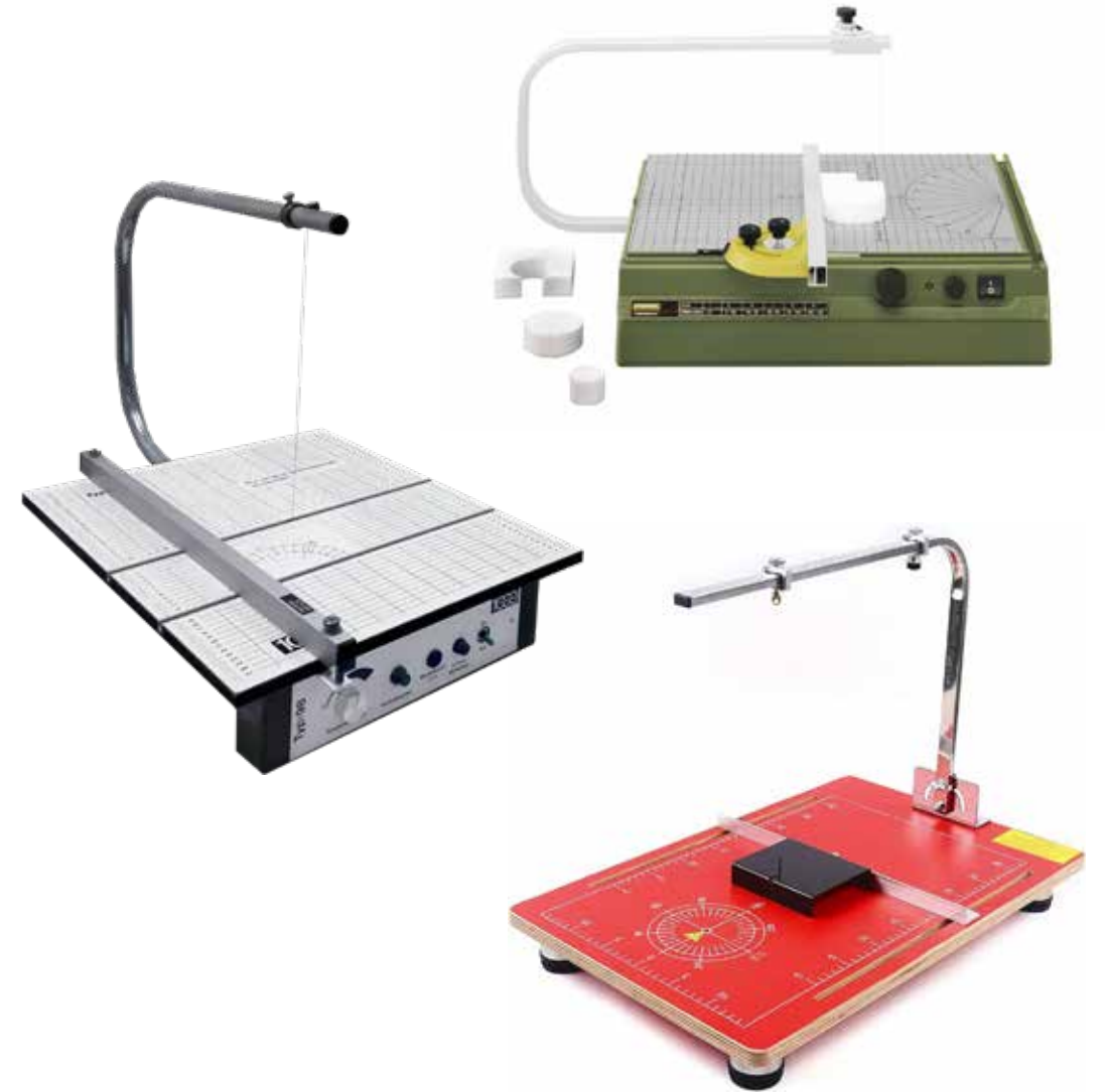
Tipologie di fili a caldo disponibili in laboratorio
